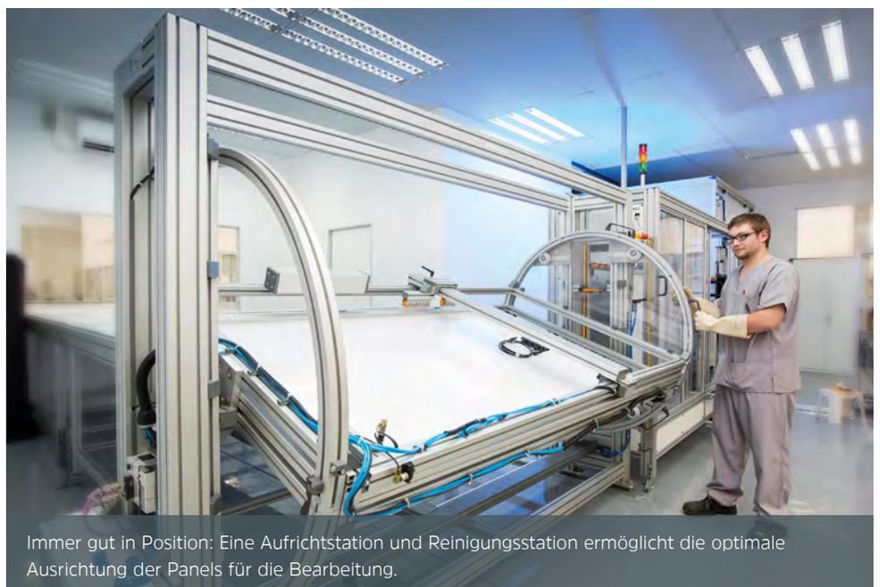
Immer gut in Position: Eine Aufrichtstation und Reinigungsstation ermöglicht die optimale Ausrichtung der Panels für die Bearbeitung.
