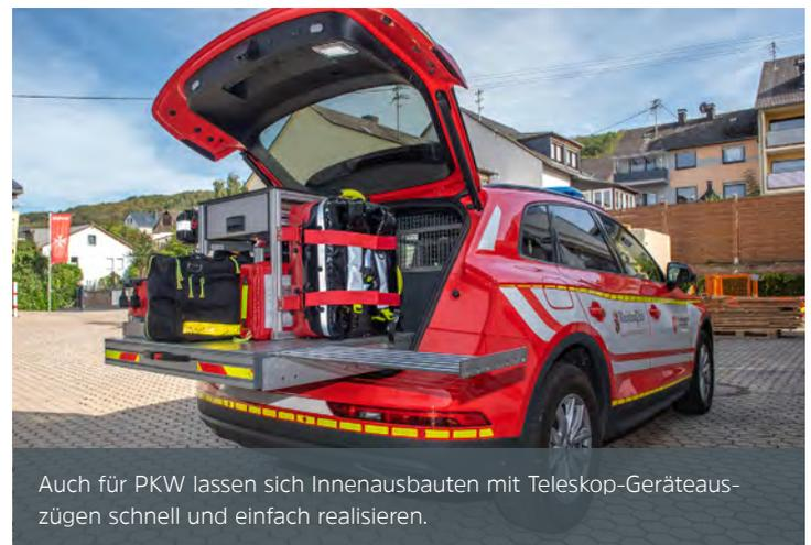
Auch für PKW lassen sich Innenausbauten mit Teleskop-Geräteauszügen schnell und einfach realisieren.
