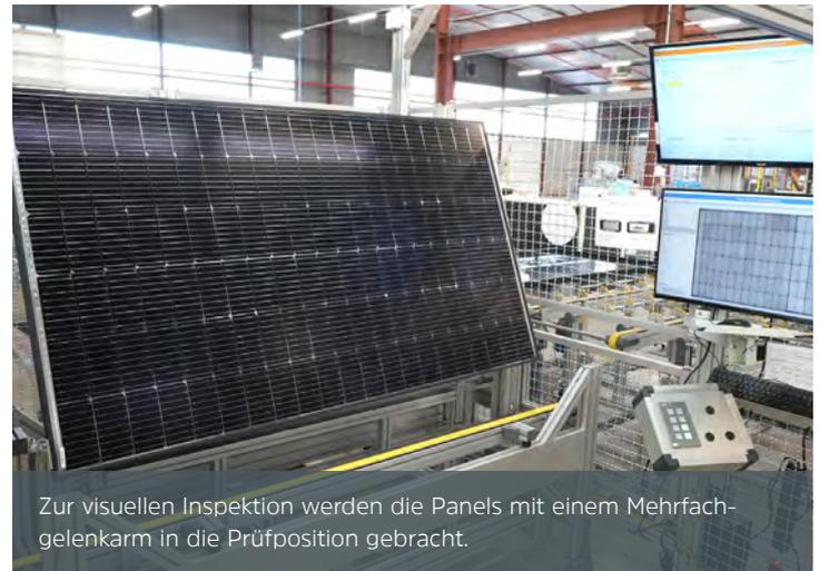
Zur visuellen Inspektion werden die Panels mit einem Mehrfachgelenkarm in die Prüfposition gebracht.
