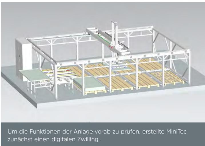
Um die Funktionen der Anlage vorab zu prüfen, erstellte MiniTec zunächst einen digitalen Zwilling.
