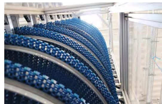
In Hallen oder Produktionsanlagen können mit dem Wendelförderer Höhenunterschiede von bis zu drei Meter überwunden werden.
