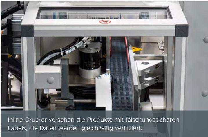
Inline-Drucker versehen die Produkte mit fälschungssicheren Labels, die Daten werden gleichzeitig verifiziert.
