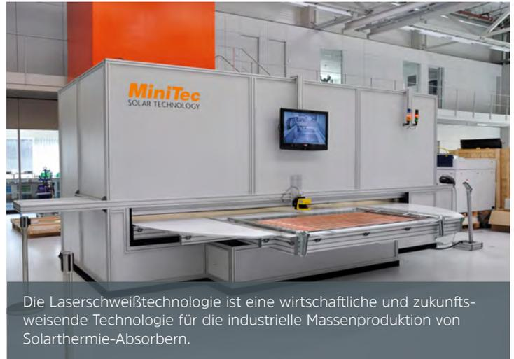
Die Laserschweißtechnologie ist eine wirtschaftliche und zukunftsweisende Technologie für die industrielle Massenproduktion von Solarthermie-Absorbern.
