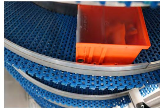
Der Turm ist ausgelegt für eine Last bis 20 kg/m Förderstrecke und eine Gesamtbelastung von 300 kg.
