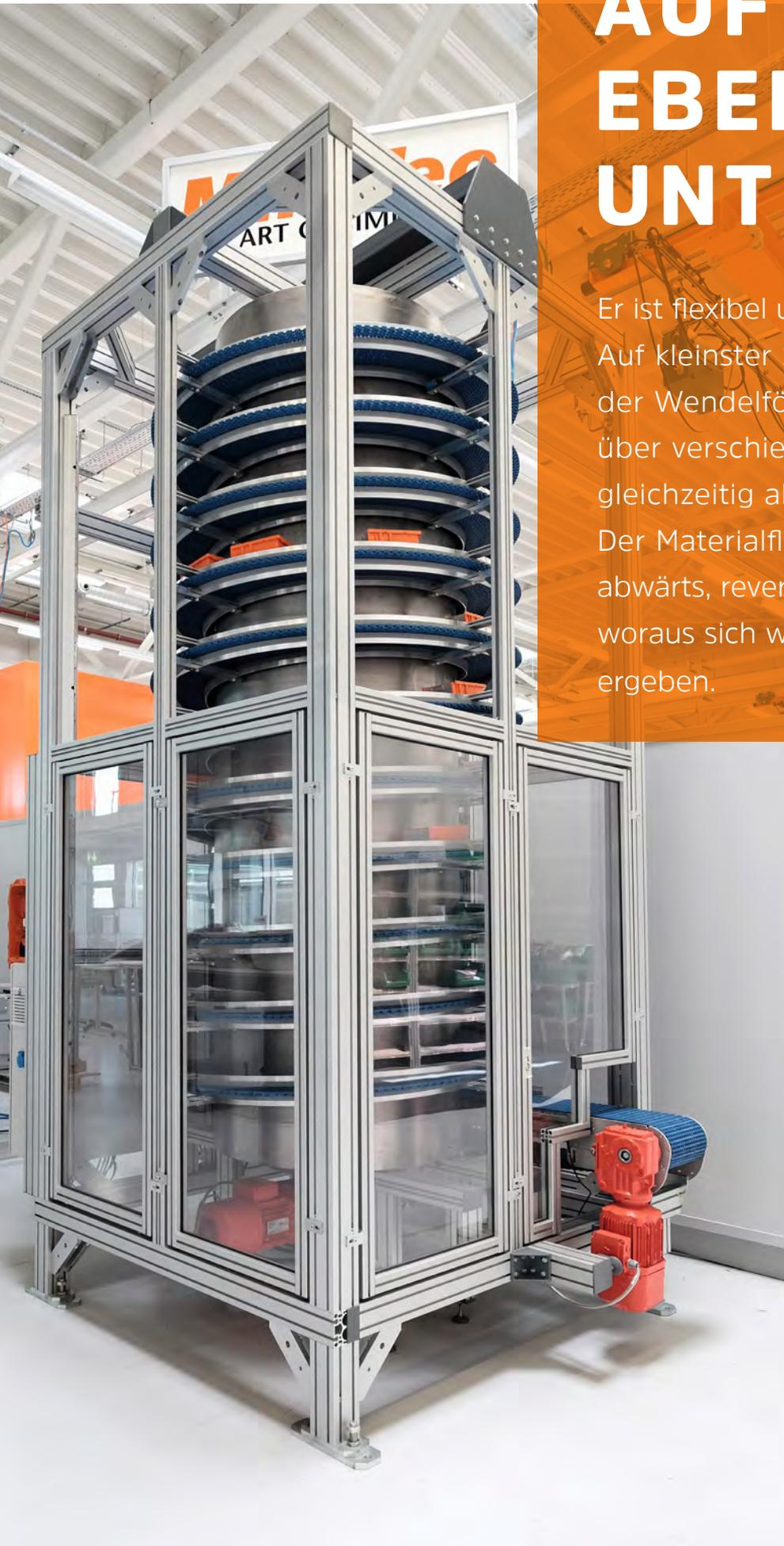
ausgelegt für eine Last bis 20 kg/m Förderstrecke und eine Gesamtbelastung von 300 kg.
