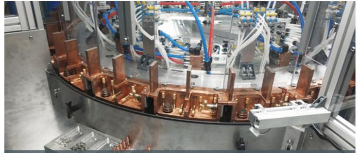
MiniTec konzipiert und fertigt maßgeschneiderte Anlagen zum flussmittelfreien Hartlöten unter Schutzgas, wie diese halbautomatische Induktionslötstation.
