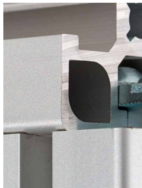
Das Rastermaß der Reihe 45 beträgt immer 22,5 mm; auch die Radien, die Nutform und die Zentralbohrung sind einheitlich. Die Nutflanken sind extrem belastungsfähig ausgelegt. Der Eckradius von 2,5 mm sorgt für einen optimalen Übergang der verbundenen Profile (Bild re.).
